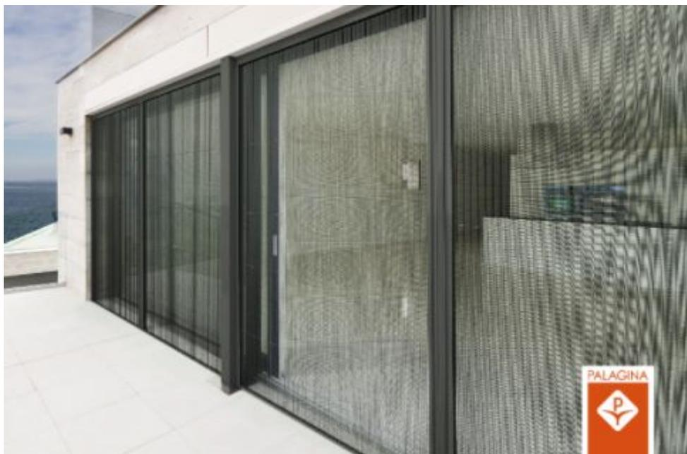
Zanzariere con cassonetto 45/50 mm, avvolgimento laterale per porte finestre, orizzontale per finestre presa ergonomica. L'apertura e chiusura dell'anta, pur essendo dotata di molla risulta molto controllata, senza causare avvolgimenti improvvisi e veloci. Finitura da campionatura Domus Trentina.
